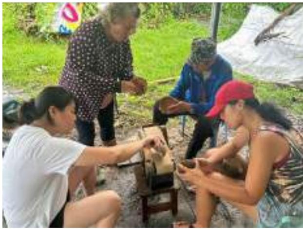
利用砂帶機研磨碗緣與底部平衡
