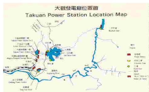
日月潭第一發電所經過五條引水鐵管路線，以流下 320.3 公尺斷崖的迴轉水庫，來轉動 2 萬千瓦的發電機五架，其所發電出的電力，透由南北百二十餘哩之特高（高壓）送電幹線，北送至霧峰、臺北各發電所，南則送至嘉義、高雄各變電所提供全省電力使用。
