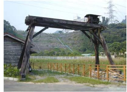
天車的位置在水里溪北岸，靠近火車站的台地上，一座依著一口大約一甲面積的大貯木池，另一座挨著鐵路軌道。從這樣的排列，即可了解木材裝卸運送的流程，所有從丹大林場運出來的原木，來到車埕後，由天車吊入貯木池浸泡，而當浸泡過的木材要輸出時，由另一座起吊到鐵軌上的輕便車，經過貯木池畔的地磅室過磅後，拖往廠區多樣化加工或轉裝貨運火車。天車與貯木池與軌道的關係，如同唇齒相依、互為循環之功能，形成共同生命體。
