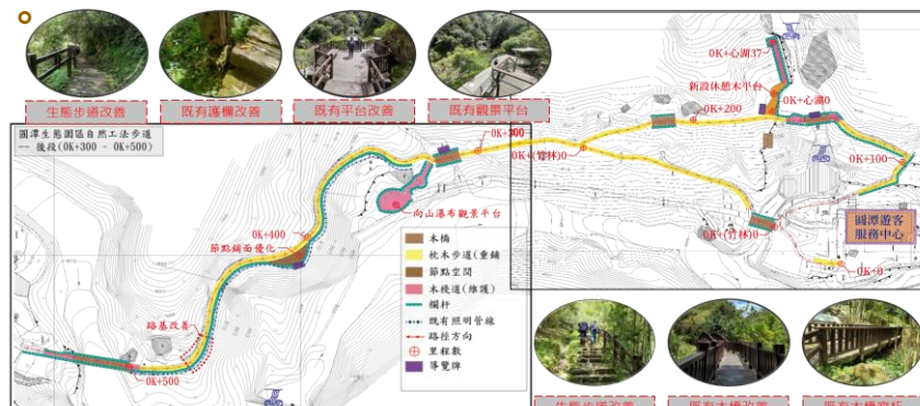
遊客服務中心後方竹林步道 主要鋪面以水泥枕木及卵石、石板鋪設的生態步道次要為木棧道、平台及木橋
