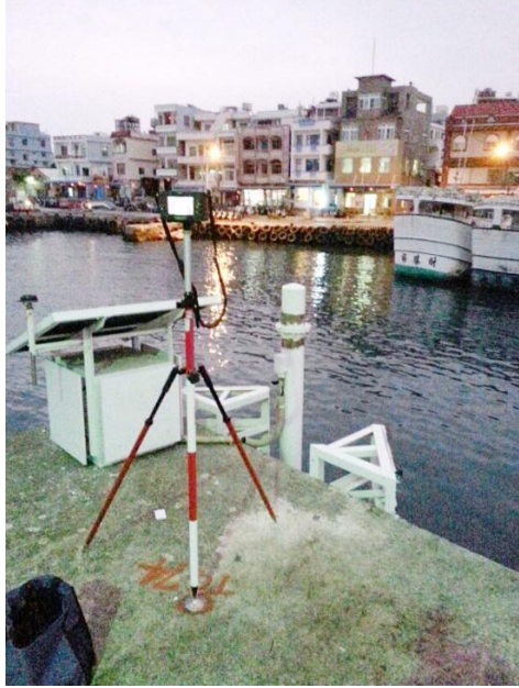
圖 9-3 小琉球潮位站水準點 GPS 靜態觀測
