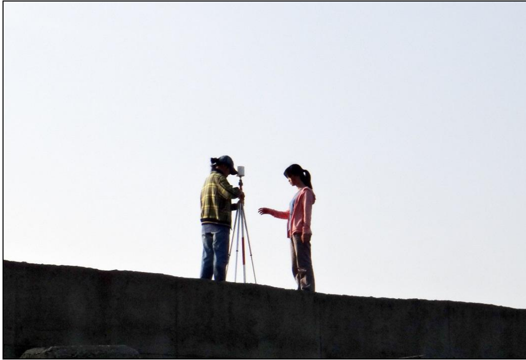
圖 9-5 控制點處架設反光覘標
