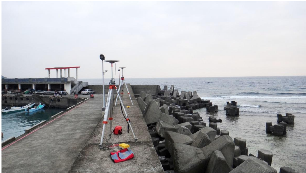
圖 9-2 杉福廊道潮間帶控制點 GPS 靜態觀測
