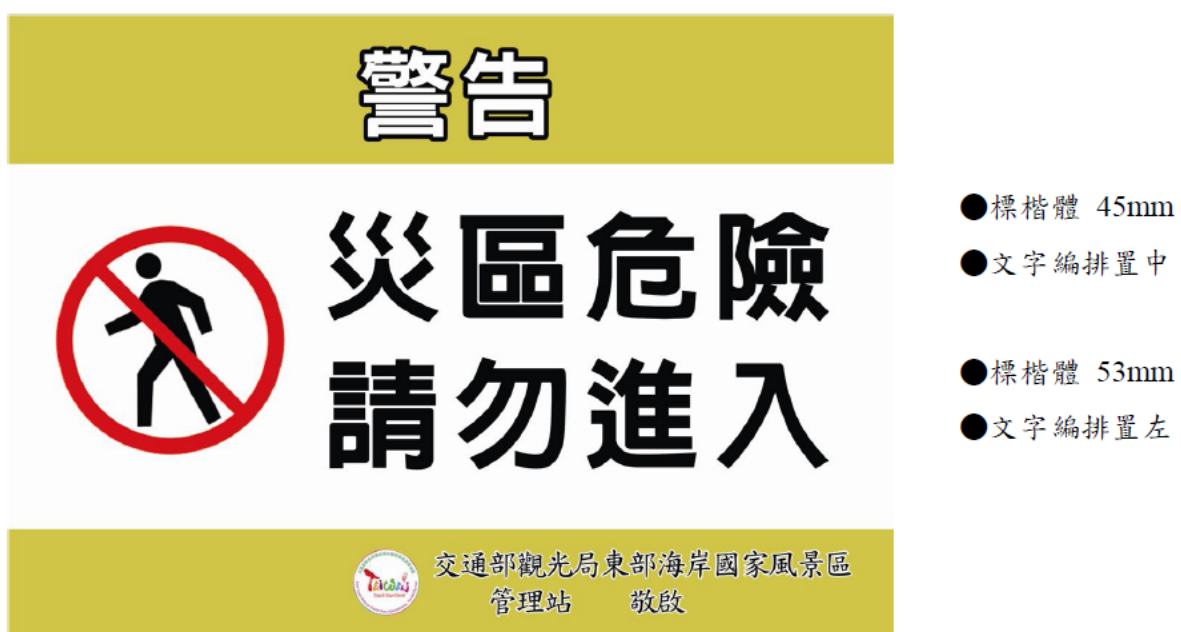
圖 20 災區危險請勿進入臨時警告牌示
