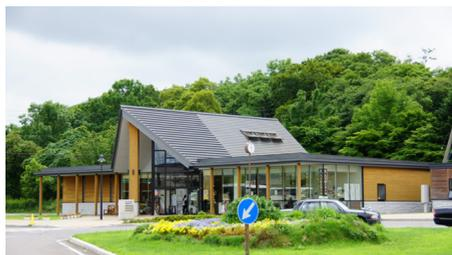
雙斜的屋頂上方，可利用突出的天窗窗臺，將日照引入、折射置室內中，應避免使用平行於屋頂斜面的天窗，容易因大雨而漏水或損壞。於東、南側開窗可導入氣流，並利用雙斜屋頂的壓力，將空氣擠至建築上方，可利用突出的天窗窗臺排出，亦可在屋脊處設置排風口，促進室內空氣的對流。
