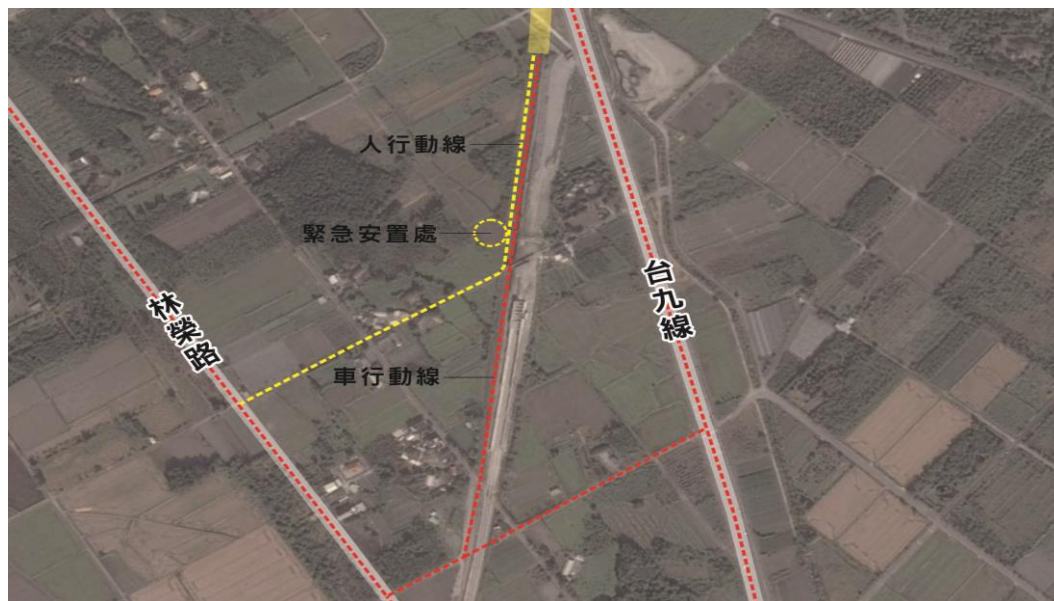
圖 8-4 舊溪口隧道南側防救災路線圖
