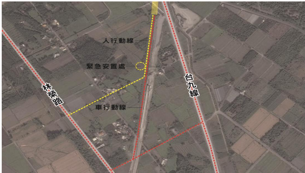
圖 34 舊溪口隧道南側防救災路線圖
