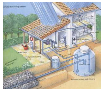
雨污水回收中水系統
