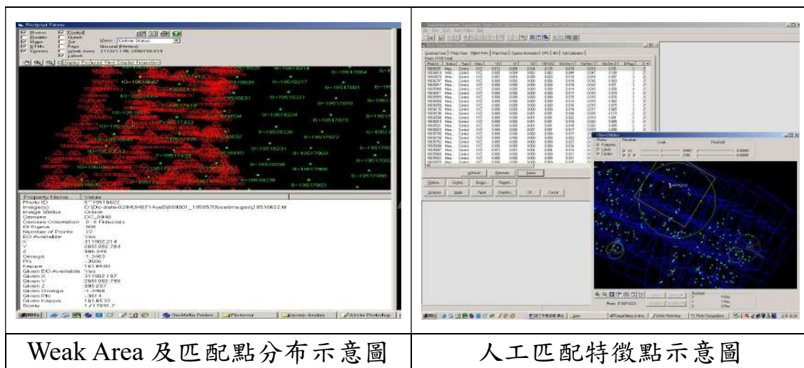
圖 3-38 空中三角平差作業示意圖
