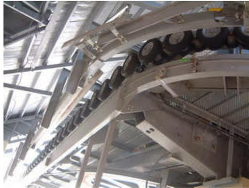
圖 6.2-2 纜車系統車廂減速裝置構造圖
